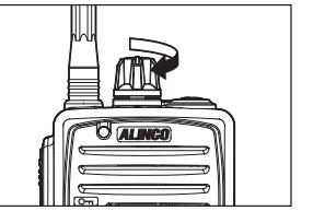
電源/音量ツマミを時計方向に回します。
