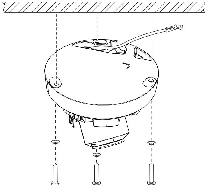
1 カメラをカメラ取付用の穴に合わせる
