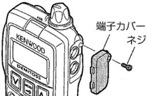
プラスドライバー(# 1)でネジを左方向に回して取り外し、端子カバーを外します。
