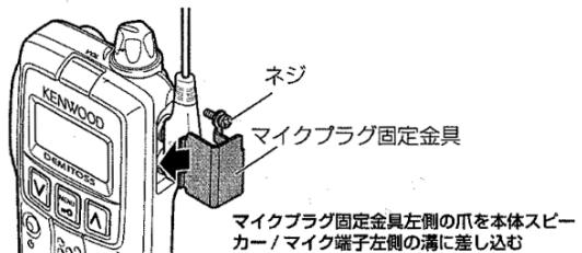
マイクプラグ固定金具左側の爪を本体スピーカー/マイク端子左側の溝に差し込む
