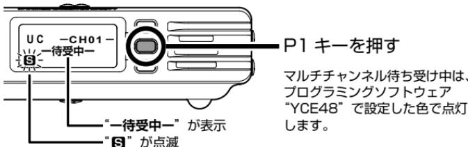
2. 信号を受信した時は、受信したチャンネルで待受が止まり相手の話を聞くことができます。その後 [P1] キーが点滅している間にマイクロホンの PTT を押すと送信することができます。
