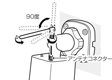
7 カメラの角度を調整し、ロックナットを回して固定します。
