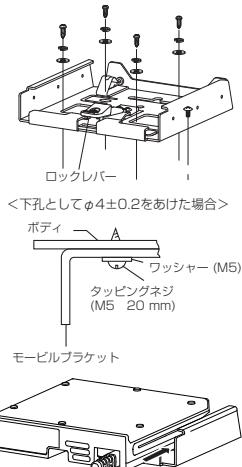
モービルブラケットのガイド部分に、本機側面にある溝を合わせ、カチッと鳴るまでスライドさせて固定します。
