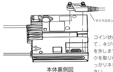
コイン状のものを使用して、ネジを緩めてプラグを外します。新しいマイクを取り付けるときはしっかりとリネジ止めしてください。
