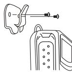
**注意** 直射日光が当る場所はさけてください。夏の日射しが液晶部に当ると一時的に画面が黒くなり見えなくなります。冷却すると元に戻ります。また、直射日光はプラスチックの様な外観部品を劣化させる原因になります。設置や取り付けに使用するネジは、付属または指定のものをお使いください。長すぎると機器内部のショート、短すぎると取り付け不安定となり、マイクが落下してディスプレイ部が割れるなどの故障の原因となります。
