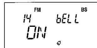
ONにするとディスプレイに♪が点灯します。信号を受信すると♪が点滅しベル音になります。次にキー操作を行うまで♪は点滅しているので、例えば不在のときに信号を受信したことがわかる「着信確認」としても使えます。
