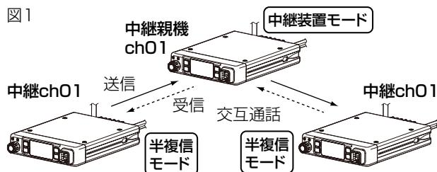
個別呼び出し機能が「ON」に設定された半複信モードの無線機(例:IC-MS5010)の中継装置として使用する場合
