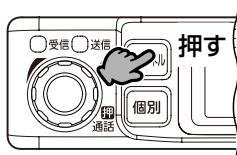
②ch表示が点滅している状態で、ツマミを回して、通話相手と同じチャンネル番号(表示例:ch02)を選択します。
