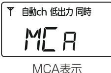
\*「MCA」は、ch01～ch18の範囲で、空きチャンネルを探し出し、その空きチャンネルを自動的に選択して通話できる方式のことです。
