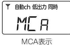
※「MCA」は、ch01～ch18の範囲で、空きチャンネルを探し出し、その空きチャンネルを自動的に選択して通話できる方式のことです。
