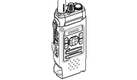
**2 無線機のアンテナに抜け防止ひもを掛けて、ホックをとめる**
