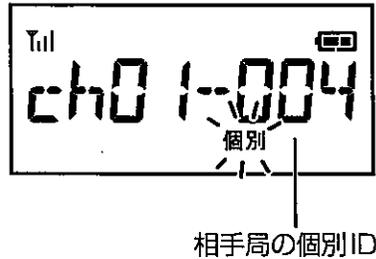
「通報ボタン」を押して「相手局の個別ID」を点滅させてから「▲」・「▼」キーで相手局を選択します。このとき「MODE」キーを押すと表示点滅の桁が移動します。もう一度「通報ボタン」を押して点滅を止めたら選択が決定します。
