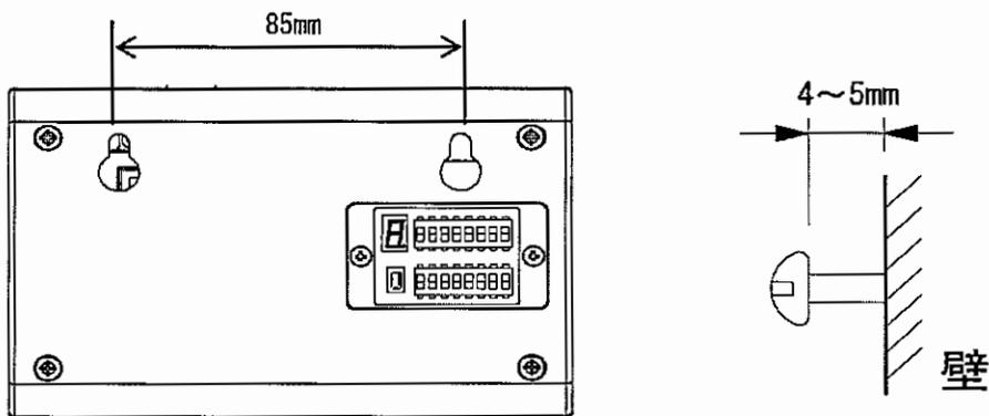
メモ 付属のねじはベニヤ板などの木製の壁用です。その他材質の壁に取り付ける際は、別途市販の専用ねじをご用意ください。
