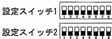
**メモ** リモコンによる遠隔操作をおこなったあとに、スイッチ操作によるチャンネル変更をおこなうこともできます。その場合はスイッチによる設定内容が優先されます。改めてリモコン操作をおこなうには、設定スイッチをすべて OFF 側に戻してください。
