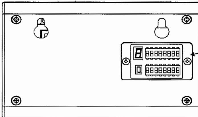
小型の＋ドライバーで、ねじ2本をゆるめ透明カバーを取り外します。
