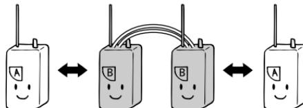
複信方式の中継器として使用するモードです。モード4、モード8でアクセスします。多段連結が可能で、遠距離の通信に利用できます。
