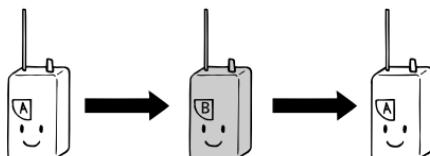
半複信方式の中継器として使用するモードです。モード3でアクセスします。
