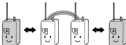
直接の通信ではつながらない相手と、中継器を介してモード2（同時通話モード）のように通信するモードです。
