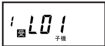
**メモ** 相手の声が途切れる場合、[モニター] キーを押してください。聞きやすくなることがあります。[モニター] キーを押すと**受**が点灯します。もう一度押すと消灯します。（「モニター機能」下記参照）
