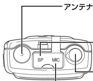
**注意** アンテナは外れないようになっています。アンテナを回したり、引き抜いたりしないでください。
