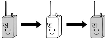
半複信方式の中継器にアクセスできるモードです。中継器を使用することによって、直接では電波が届かない相手と通信することができます。周波数構成が同じであれば、他の特定小電力トランシーバーとも中継器を介して通信できます。
