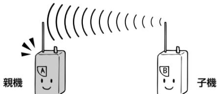
簡易的なビーコンとして使用するモードです。子機が発する電波の強度を音によって知らせます。
