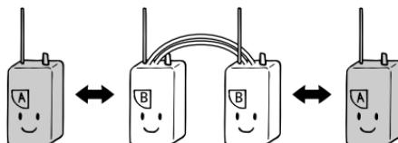
直接の通信ではつながらない相手と、連結中継器を介してモード1（交互通話モード）のように通信するモードです。
