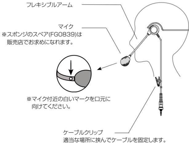
マイクの受音部側(白いマークがある側)を口元に向けてください。フレキシブルアームを曲げてマイクを口の近くまで(1~2cm)調整します。本体をスポンの上部などにクリップで挟み、固定します。
