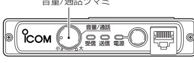
● IC-MS4055/IC-MS4066で通話を終了するときは、[音量/通話]ツマミを押すか、マイクロホンの[通話]スイッチを“OFF”にすると、ビープ音が“ブブポッ”と鳴って、送信表示LED(赤色)と受信表示LED(緑色)が消灯し、両者とも(呼び出した方も呼び出された方も)回線が切れます。
