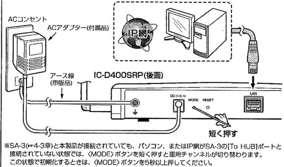
※SA-3(※4-3章)と本製品が接続されている場合、パソコン、またはIP網がSA-3の〔To HUB〕ポートと接続されていない状態では、〈MODE〉ボタンを短く押しと運用チャンネルが切り替わります。この状態で初期化するときは、〈MODE〉ボタンを5秒以上押ししてください。
