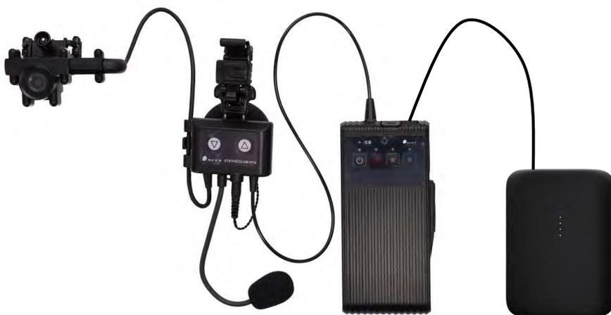
※ 外付けバッテリーの充電が無くなると、自動的に内部バッテリーから給電します。
